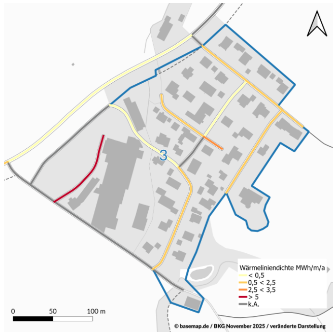
Wärmeliniedichte (Indikator für Wärmenetz)
