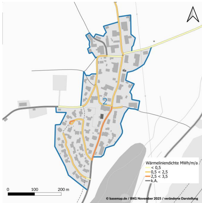
Wärmeliniedichte (Indikator für Wärmenetz)
