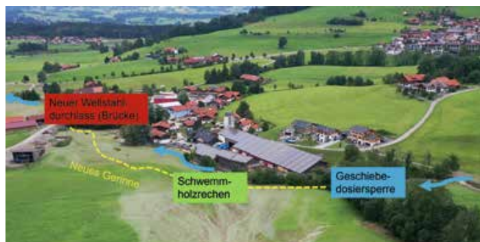
Abbildung 1: Luftbild von Altach mit den geplanten Schutzbauwerken.
